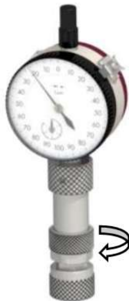
Рисунок 6.2 – Подключение калибра к измерителю
