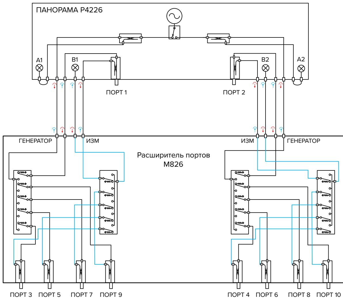
Схема расширителя с вынесенными направленными ответвителями на каждый измерительный канал позволяет получать высокую стабильность калибровки и обеспечивает минимальное ухудшение эффективных параметров измерителя.
