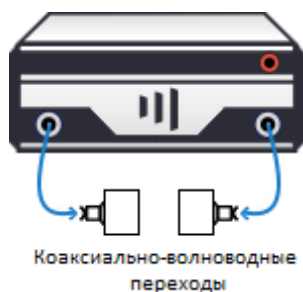
Рисунок 3.26 – Измерения в волноводном тракте
