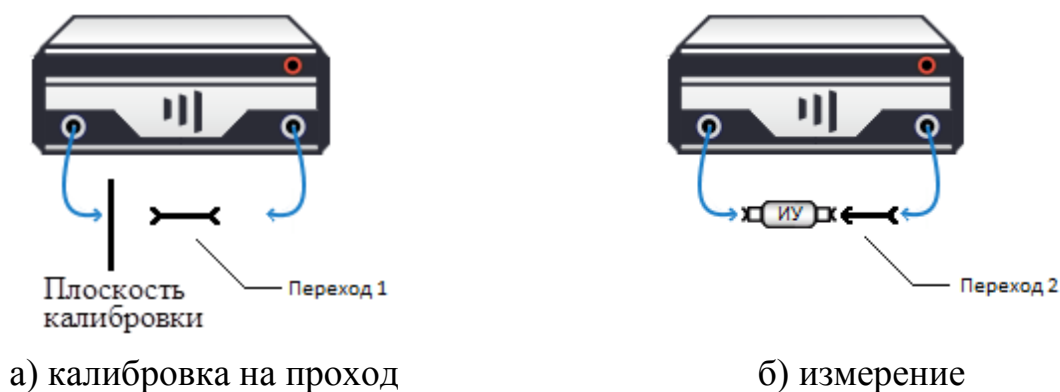
Рисунок 5.25 – Использование эквивалентных переходов
