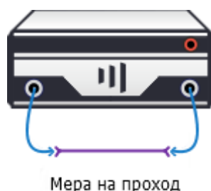
Рисунок 3.13 – Калибровка на проход
