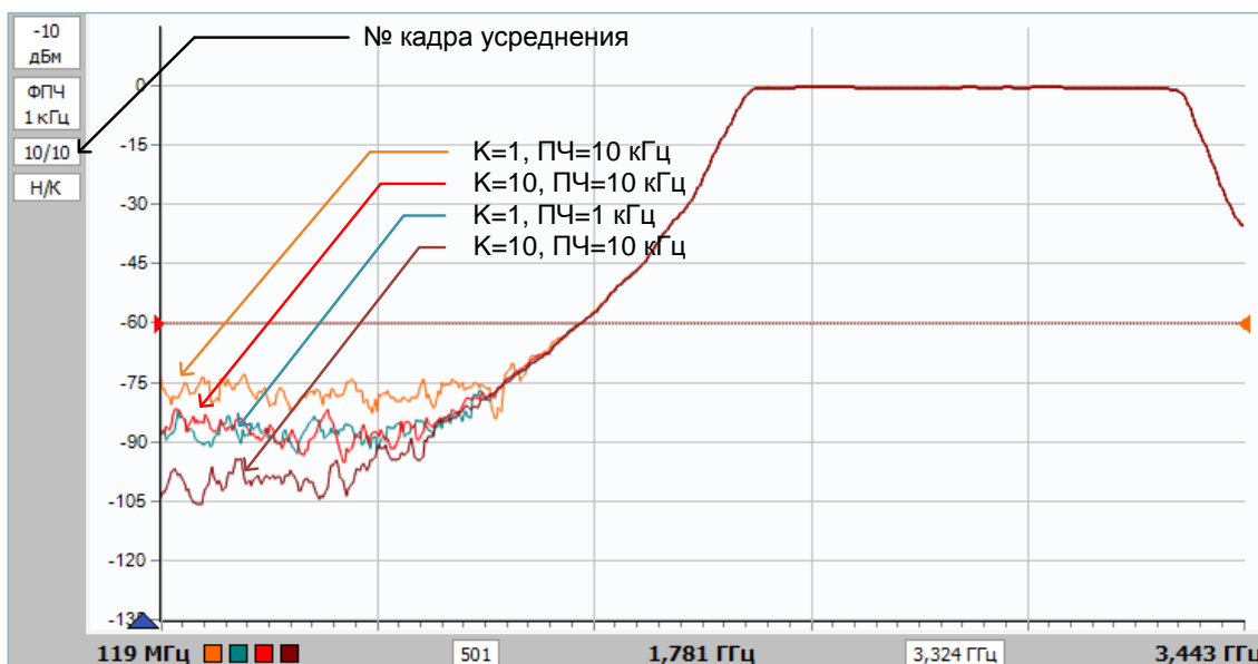
Рисунок 5.2 – Влияние усреднения и полосы пропускания фильтра ПЧ
