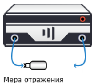
Рисунок 3.15 – Калибровка на ХХ и КЗ
