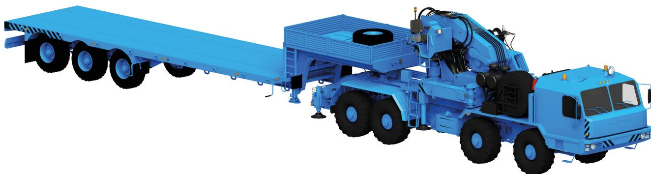
УТЗМ-Т предназначена для транспортирования, временного хранения, загрузки, выгрузки, перегрузки различных грузов, в том числе опасных.
