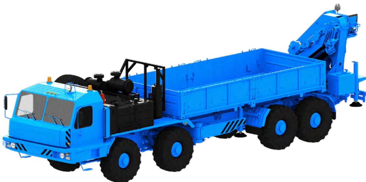
УТЗМ-Л предназначена для транспортирования, временного хранения, загрузки, выгрузки, перегрузки различных грузов, в том числе опасных.
