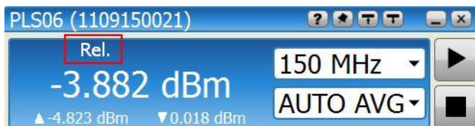
Рисунок 7.9 – Отображение результатов измерений мощности с индикацией использования опорного уровня
