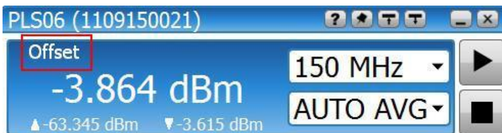
Рисунок 7.8 – Отображение результатов измерения мощности с индикацией математического смещения
