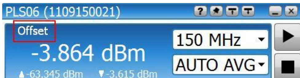
Рисунок 7.19 – Индикация математического смещения результатов измерений в основном окне ПО PLS-Client
