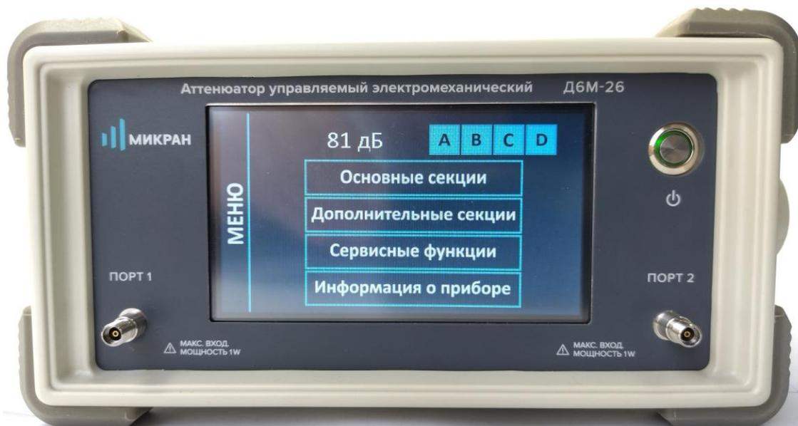
Рисунок 7.1 – Аттенуатор Д6М-26-13Р, передняя панель
