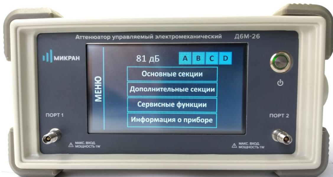
Рисунок 7.3 – Аттенюатор серии Д6М готов к работе
